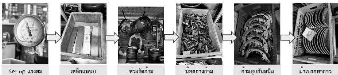
ภาพที่ 3 จัดเตรียมอุปกรณ์ประกอบก้ามตามลำดับการผลิต
