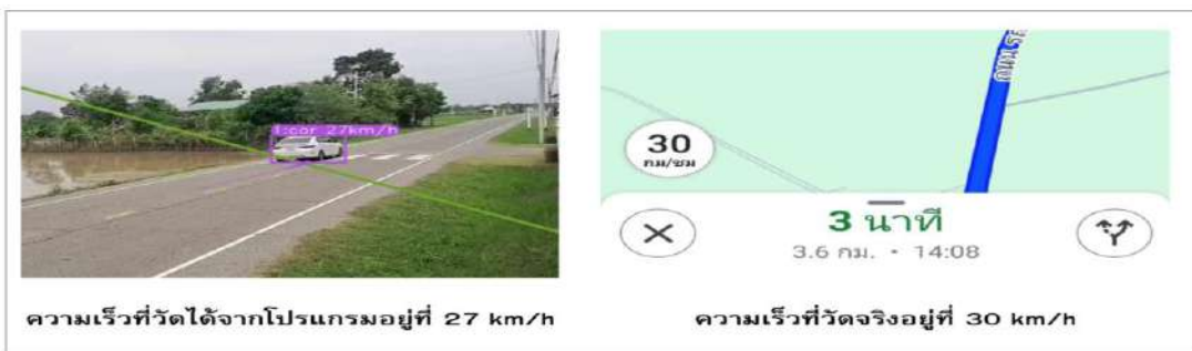
ภาพที่ 4 ความเร็วที่วัดได้จากโปรแกรม 27 km/h และความเร็วที่วัดได้จริง 30 km/h
