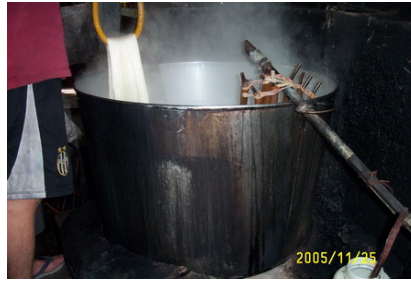
ภาพที่ 1.1 การฟอกไหมของร้านอุ๊ยบ้านครัวไหมไทย
