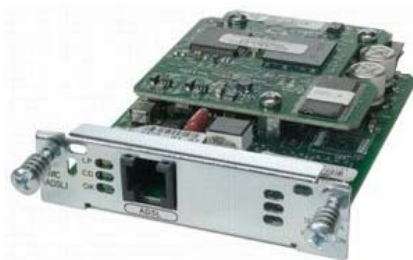
ภาพที่ 3.9 ภาพแสดงอุปกรณ์เครือข่ายคอมพิวเตอร์โมเดล HWIC-1ADSL
