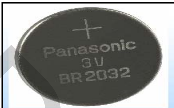
ภาพที่ 3.13 อุปกรณ์อิเล็กทรอนิกส์ที่เรียกว่า BATTERY 3V BR2032
