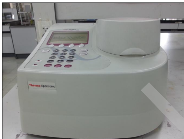
ภาพที่ ค-1 เครื่อง UV-Vis Spectrophotometer บริษัท Thermo Scientific (USA)
