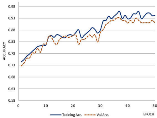
ก. กราฟแสดงค่าความถูกต้องของการเรียนรู้ รูปที่ 7 ประสิทธิภาพการจำแนกโรคใบมะเขือเทศด้วย CNN, อัตราการเรียนรู้ 0.001 ที่จำนวน 50 รอบ
